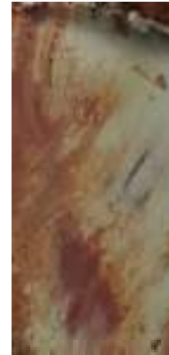
FURO 02 - AM-02 ARGILA CINZA COM RAJAS VERMELHA
