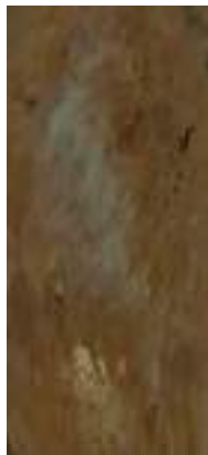
FURO 03 - AM-11 ARGILA MARROM COM RAJAS CINZA E CARBONATO
