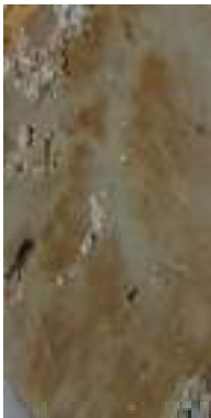
FURO 04 - AM-15 ARGILA CINZA COM RAJAS MARROM E CARBONATO
