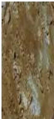
FURO 08 - AM-11 ARGILA MARROM COM RAJAS CINZA E CARBONATO
