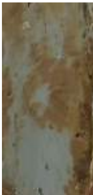
FURO 07 - AM-11 ARGILA MARROOM COM RAJAS CINZA E CARBONATO
