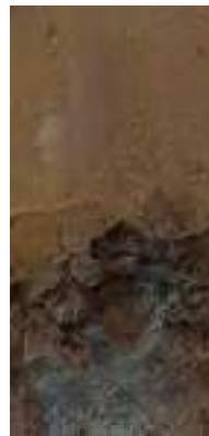
FURO 08 - AM-12 ARGILA MARROM COM RAJAS CINZA E CARBONATO
