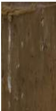
FURO 10 - AM-17 ARGILA MARROM COM RAJAS CINZA E CARBONATO
