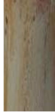
FURO 03 - AM-02 ARGILA CINZA COM RAJAS VERMELHA
