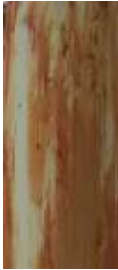
FURO-03 - AM-01 ARGILA CINZA COM RAJAS VERMELHA
