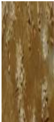
FURO 06 - AM-11 ARGILA MARROM COM RAJAS CINZA E CARBONATO
