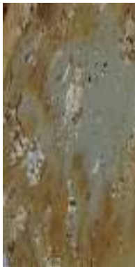
FURO 10 - AM-15 ARGILA MARROM COM RAJAS CINZA E CARBONATO
