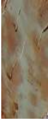
FURO-01 - AM-01 ARGILA CINZA COM RAJAS VERMELHA
