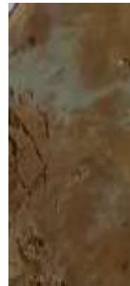
FURO 03 - AM-10 ARGILA MARROM COM RAJAS CINZA E CARBONATO
