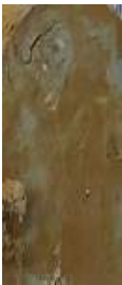
FURO 08 - AM-09 ARGILA MARROM COM RAJAS CINZA E CARBONATO
