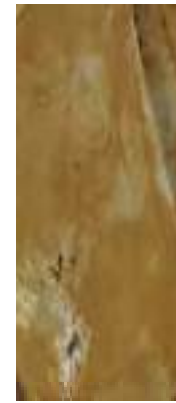
FURO 06 - AM-12 ARGILA MARROM COM RAJAS CINZA E CARBONATO
