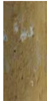
FURO 01 - AM-12 ARGILA MARROOM COM RAJAS CINZA E CARBONATO
