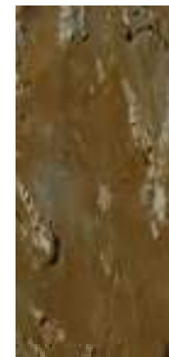
FURO 03 - AM-16 ARGILA MARROOM COM RAJAS CINZA E CARBONATO
